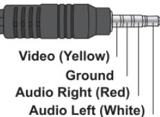
Formato de cable adaptador de Jack a RCA compatible
