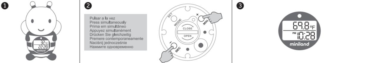
Configuración del reloj y de la alarma de temperatura alta · Clock and High temperature alarm set-up
